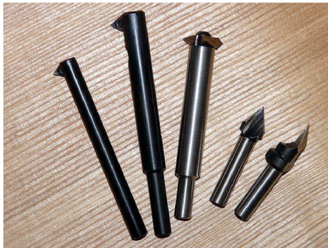
Fräser (60°) zum Gewindefräsen in Holz
